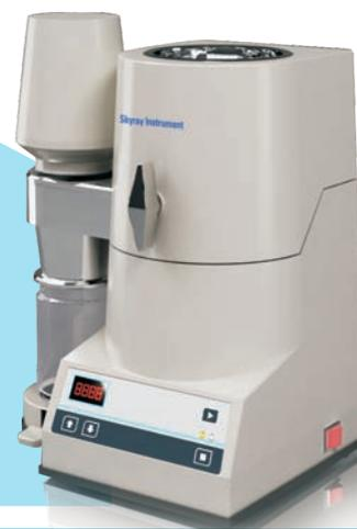
SHM1000 锤片式粮食实验粉碎机是一种圆盘式磨粉机，用于粉碎谷粒、豌豆、玉米、大豆等产品。仪器采用圆盘式设计，样品在锋利的钢盘内被快速粉碎，通过旋风收集迅速释放入塑料样品杯，减少了在样品在磨内停留时间，降低热量的产生，将水分的损失降至最低。进样系统采用与转速联动设计，自动开启进样系统，以恒定的进给速度，这就改善了高水分谷物和谷壳的研磨，如大麦、燕麦和大米，并且恒定的进给速度也提高了整体性能和降低粉碎磨电机引起的劳损过量。
